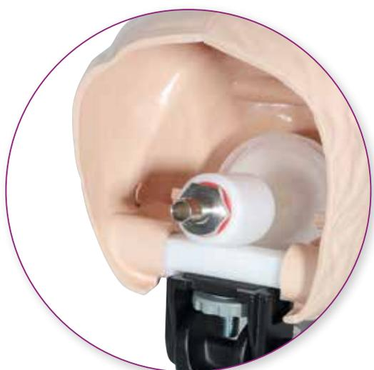
过滤器支架和适配器位于面部模型嘴唇后面的空腔中
