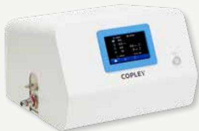
利用临界流量控制器系列简化干粉吸入剂测试系统装置，使其符合药典建议。TPK 100i型临界流量控制器位于撞击器和真空泵之间，可确保测试期间的临界（声波）流量条件。它可以测量和记录测试和控制流量条件所需的所有参数。
