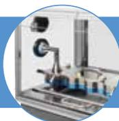
NGI降温柜™只能用于带有吸嘴的雾化吸入剂。对于带面罩的雾化吸入剂，在达到所需温度后，需要将NGI从NGI降温柜中取出进行测试。
