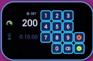
设置振摇速度 (RPM)
