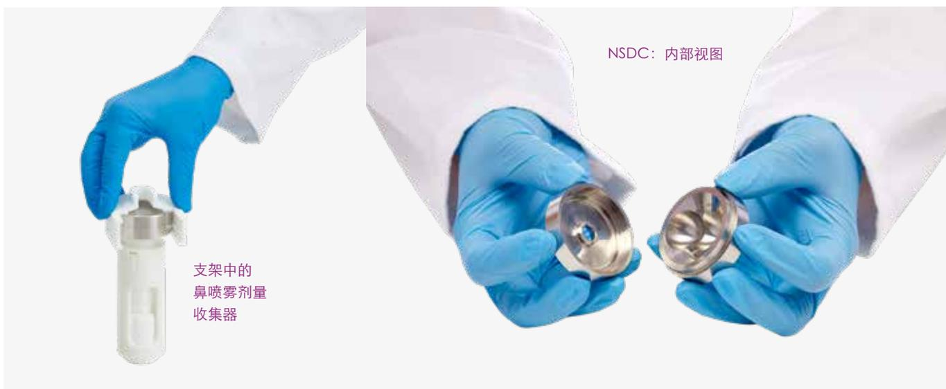
鼻喷雾剂量收集器 (NSDC) 的开口足够大，可以防止飞溅，但又足够小，可以大大降低滴落和泄漏的风险，不仅可以确保准确收集全剂量，还可以使剂量收集以垂直方向进行，以更好地转移体内使用。鼻喷雾剂量收集器
