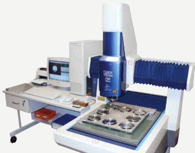
使用Mitutoyo QV404视觉检测系统对ACI层级进行测量
